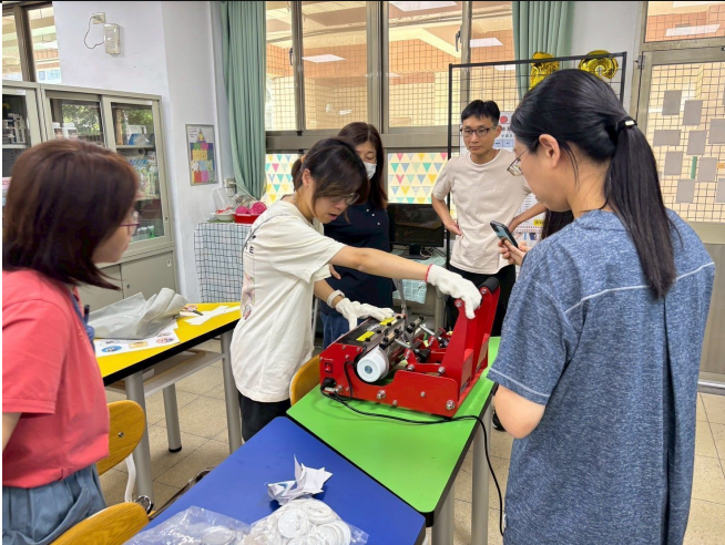
09 熱轉印工作坊_熱轉印機操作教學
