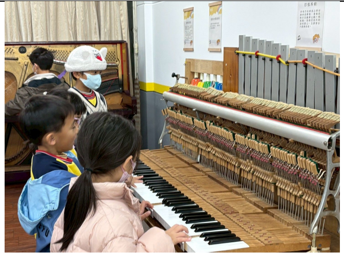
02【探索音律之美】學生認真聆聽導覽老師解說鋼琴構造與琴槌敲弦系統，透過視覺與聽覺的結合，深化對樂器科學的認識。
